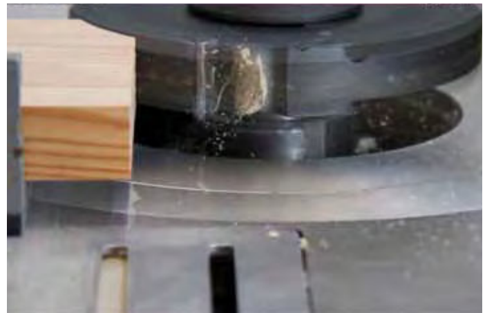
Chip flow system: designed to optimize the chips discharge. Forgácsáramlási rendszer: a forgácseltávolítás optimalizálása.
